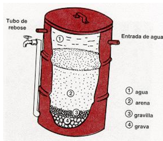
Abbildung 9-2 Langsandsandfilter auf Haushaltsebene /37/
